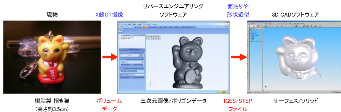
図 6: CAD リンクの処理の流れ
