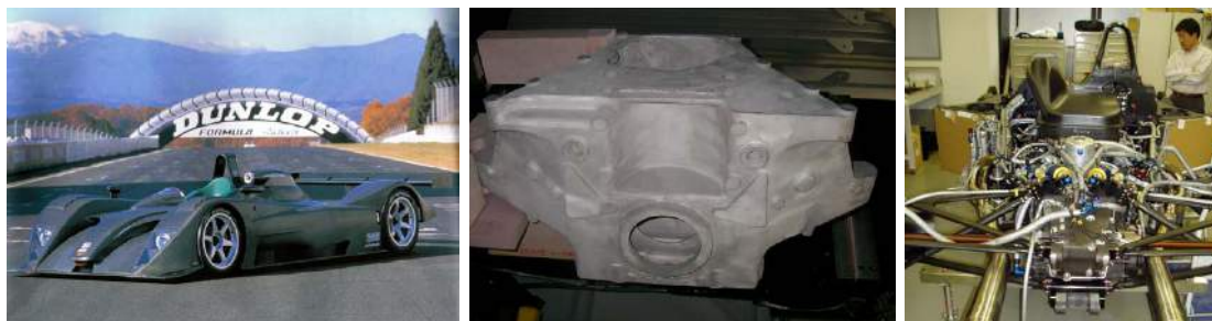
エンジン構成部品「ベルハウジング」、マグネシウム合金による鋳造品、約20kg
